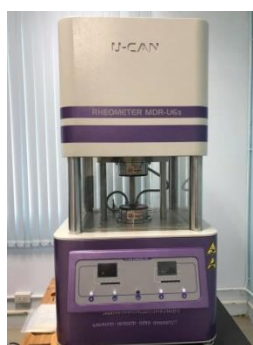
รูปที่ 5 เครื่องทดสอบสมบัติการคงรูปของยาง (Moving Die Rheometer)
