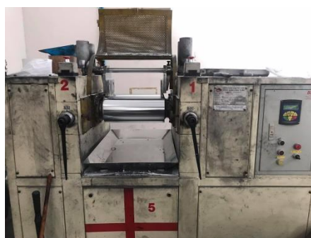
รูปที่ 3 เครื่องบดผสมยางสองลูกกลิ้ง (Two roll mill)
