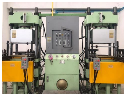
รูปที่ 6 เครื่องอัดเบ้า (Compression Molding Machine)
