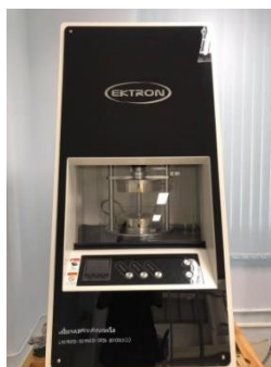
รูปที่ 4 เครื่องทดสอบความหนืดของยาง (Mooney viscometer)
