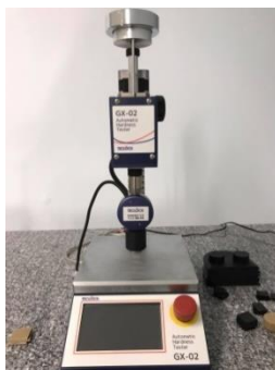
รูปที่ 7 เครื่องทดสอบความแข็ง (Automatic Hardness Tester)
